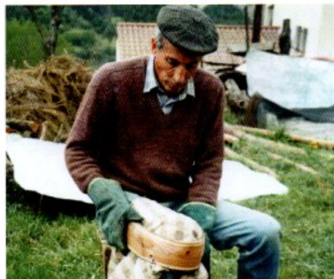
> Charles Aillaud fabriquant un « chambis » ou collier de sonnaille, on le voit ici ployer une lame de cytise sortie d'étuvage.
